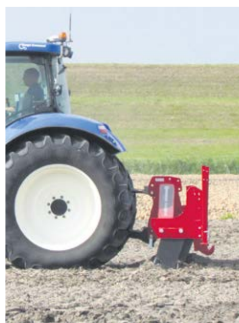
Kongskilde Paragrubber zorgt voor een goede beluchting van de grond zonder te mengen.
