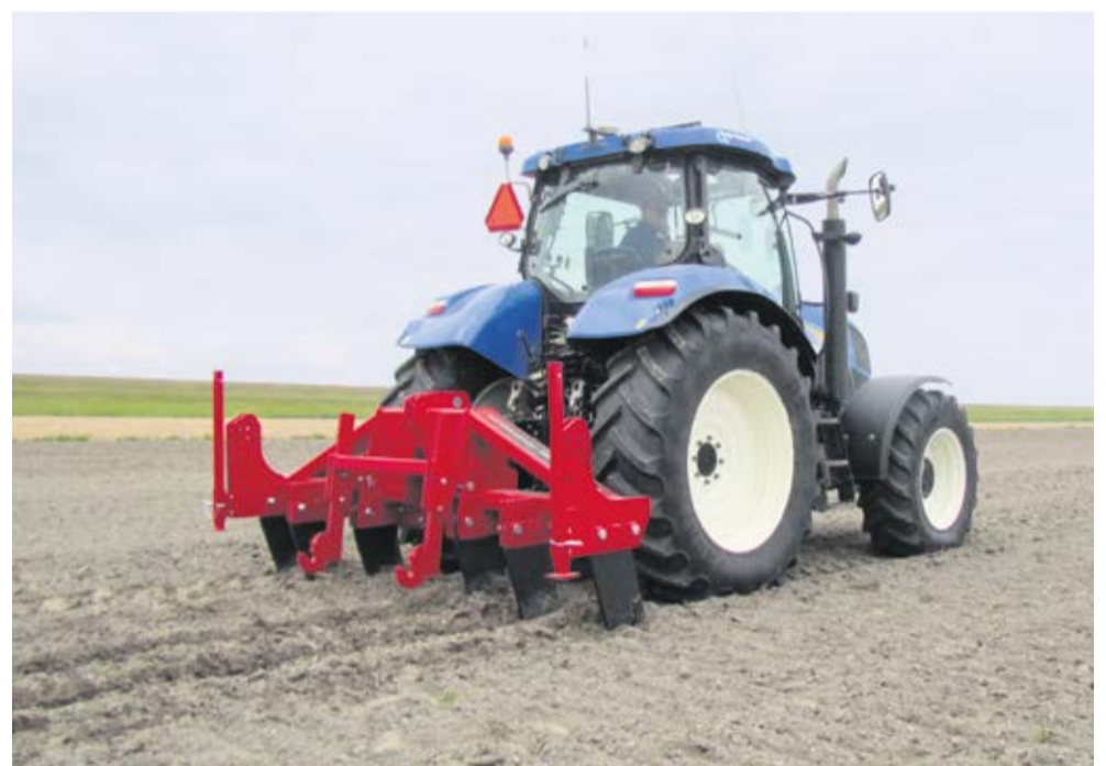
Kongskilde Paragrubber zorgt voor een goede beluchting van de grond zonder te mengen.
